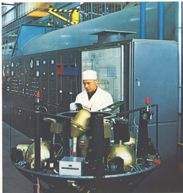
Aeritalia: montaggio degli apparati del satellite per telecomunicazioni « Sirio » messo in orbita nell'agosto 1977
