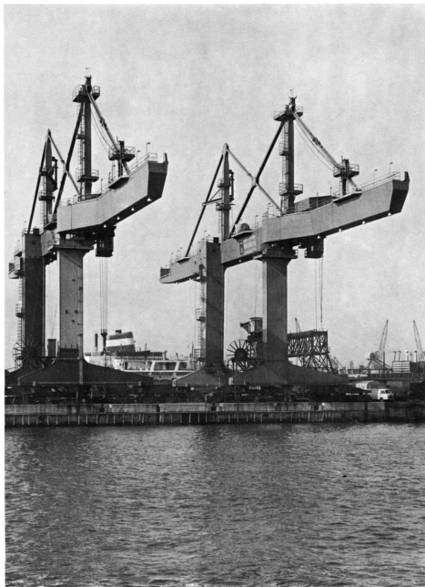
C.M.I. - Costruzioni Meccaniche Industriali Genovesi scaricatori di carbone e minerali da 500 t. h. (portata alle funi t. 20)
