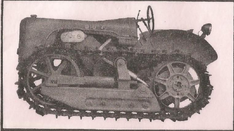
Il motore è un bicilindrico Diesel 4 tempi ad iniezione diretta, sovralimentato con aria depurata. Lubrificazione filtrata e forzata.
