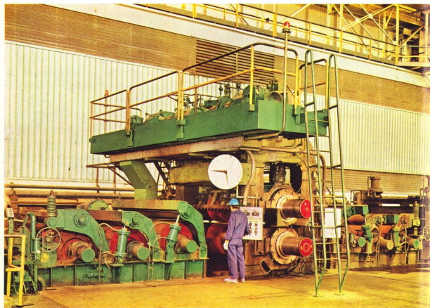
Stabilimenti di Sant'Eustacchio, Brescia. Producono cilindri per laminatoi, macchine utensili, per siderurgia e getti in ghisa. Nella foto: gabbia laminatoio Duo Temper da 34" x 80" recentemente installata in un nuovo stabilimento siderurgico.
