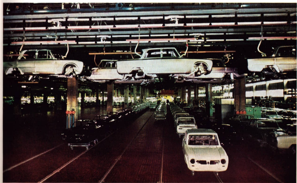
Alfa Romeo, Milano. Nel nuovo stabilimento di Arese sono già in esercizio i reparti relativi alla produzione carrozzerie, assemblaggio finale e collaudo delle Giulia. Nella foto: trasporto aereo scocche dalla verniciatura alle linee di montaggio.
