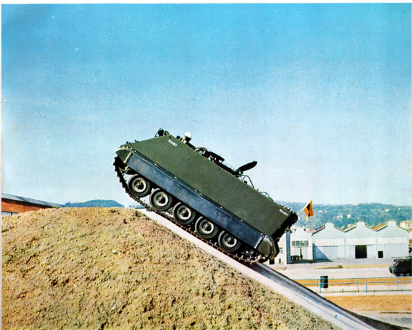
OTO Melara, La Spezia. L'attività produttiva dell'azienda è in continuo sviluppo: in essa assume particolare rilievo la commessa di carri blindati M 113 per l'Esercito italiano. Nella foto: uno di tali mezzi al collaudo su terreno a forte pendenza.
