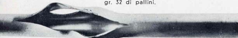
Fig. 3 - Scoppio provocato sparando una cartuccia corazzata (36 gr.) con canna ostruita da una borra e 36 gr. di pallini.
